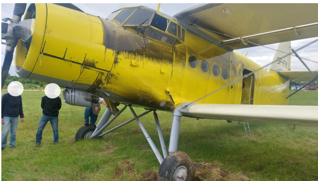
Rys. 3. Samolot po lądowaniu. Widoczne zewnętrzne zabrudzenia wyciekającym olejem. [źródło: załoga samolotu].
