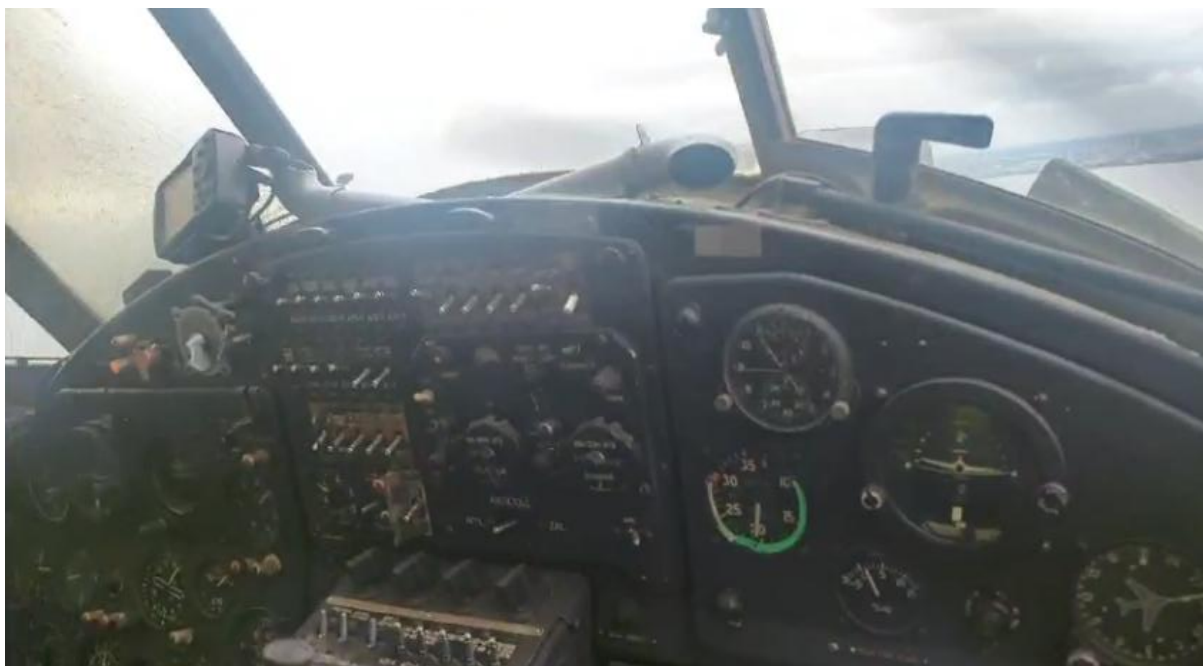
Rys. 2. Widok z kabiny załogi podczas przedmiotowego lotu. Na lewej szybie widoczne ślady wycieku oleju [źródło: załoga samolotu]
