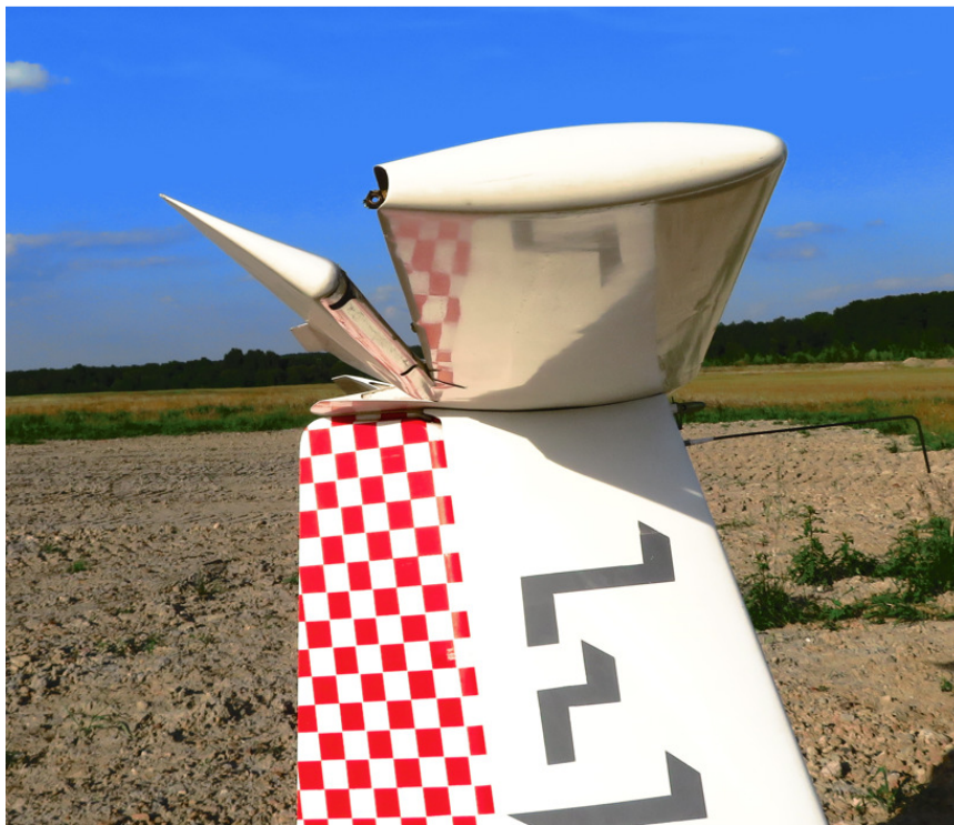
Rysunek 3. Wyrwany z zawiasów ster wysokości
