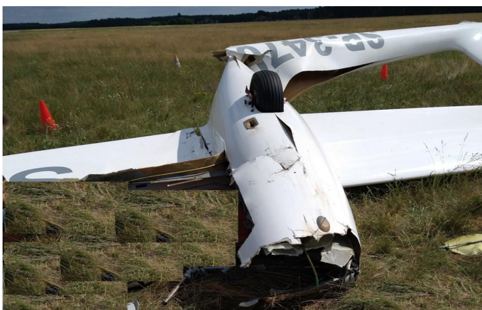
Rys. 4. Położenie szybowca po zdarzeniu i widoczne uszkodzenia strukturalne [źródło: PKBWL]
