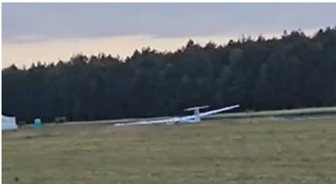
Rys. 1. Rozbieg szybowca, wyraźnie widoczne przechylenie na lewe skrzydło oraz uniesiony ogon [źródło: materiał świadka]
