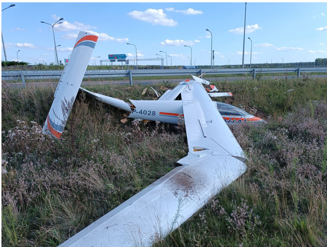
Rys. 2 Wrak szybowca po zderzeniu z infrastrukturą węzła drogowego [źródło: PKBWL]
