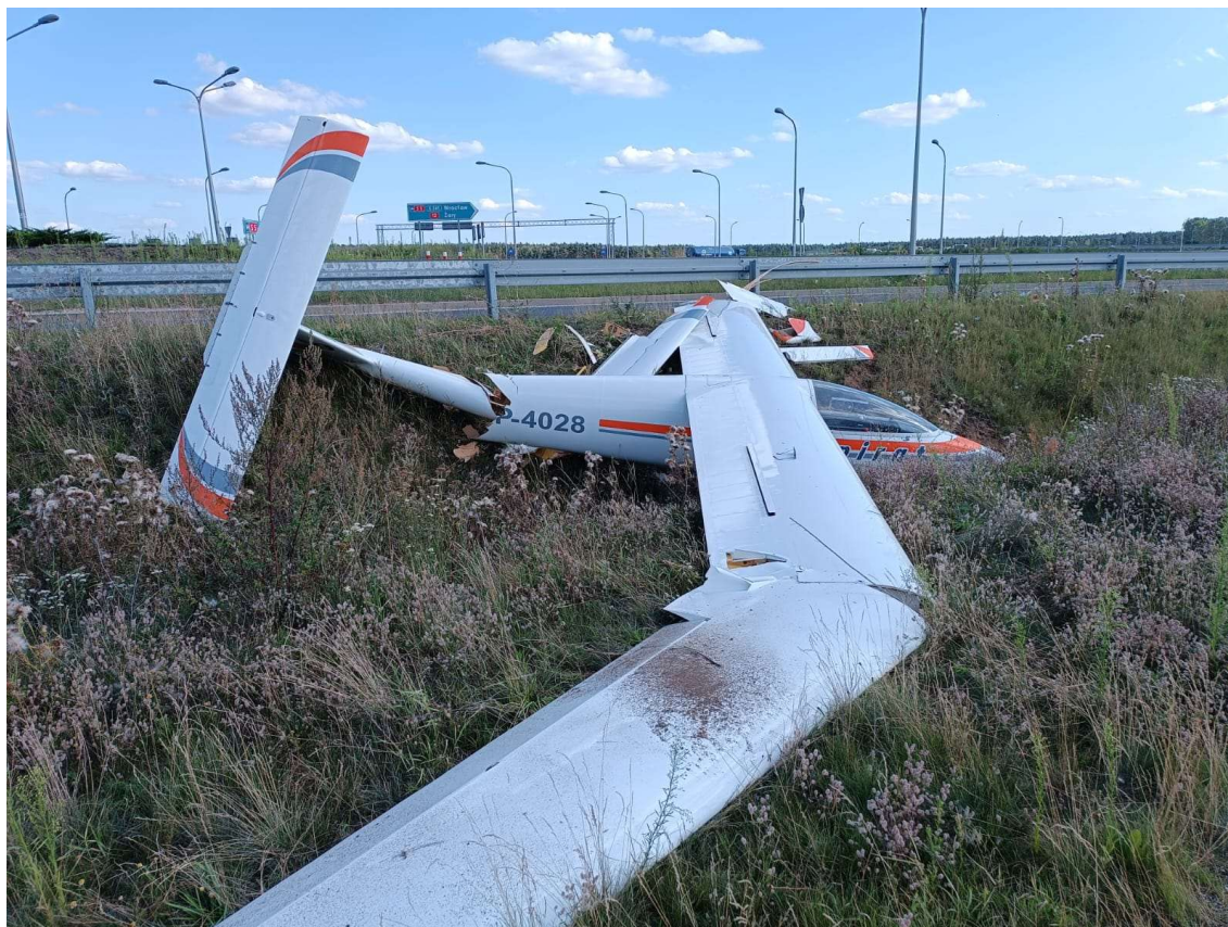
Rys. 1 Wrak szybowca po zderzeniu z infrastrukturą węzła drogowego [źródło: PKBWL]
