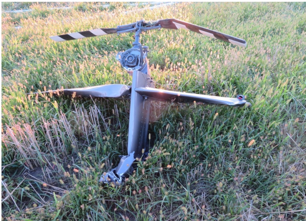
Rys. 3. Część belki ogonowej z przekładnią końcową i śmigłem ogonowym
