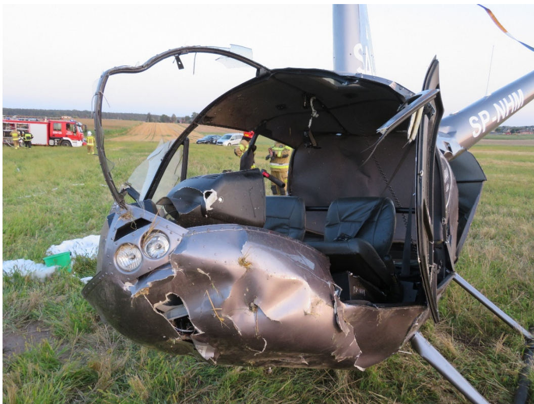
Rys. 6. Zdeformowana lewa strona kabiny śmigłowca
