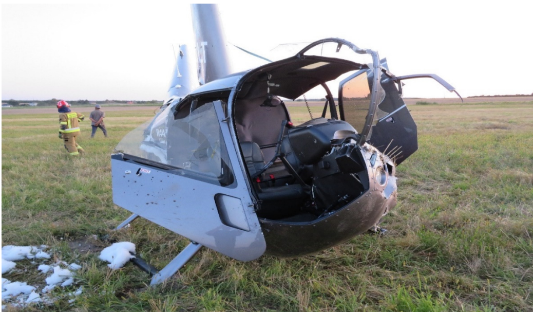
Rys. 5. Zdeformowana prawa strona kabiny pilota
