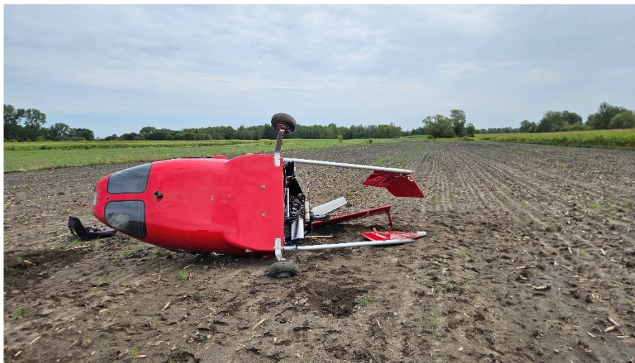
Rys. 2. Uszkodzenia SP (źródło: Pilot SP)
