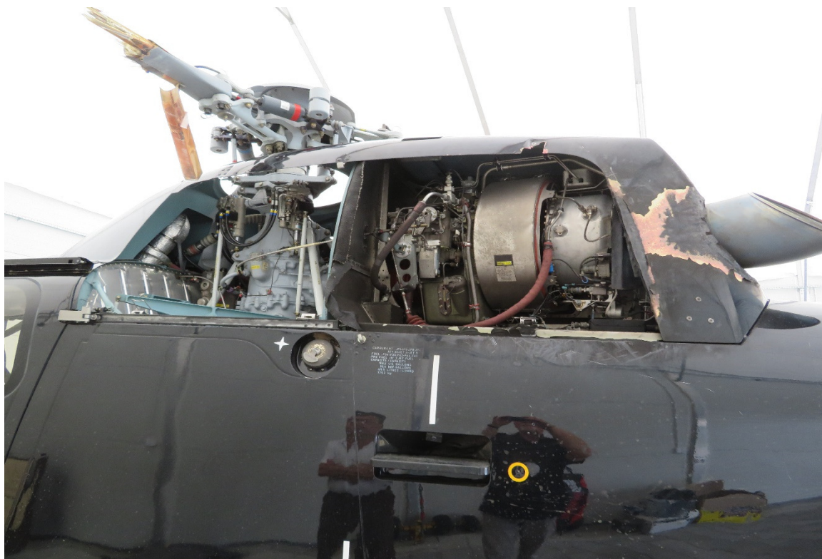
Rys. 6. Widoczne zmiany termiczne na kadłubie po gorącym rozruchu silnika.
