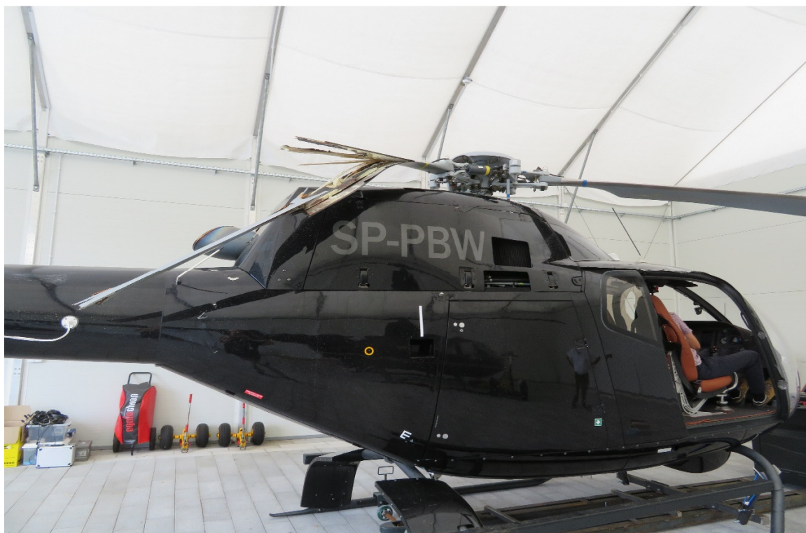
Rys. 5. Uszkodzenia piasty wirnika głównego, łopat wirnika głównego oraz kadłuba.
