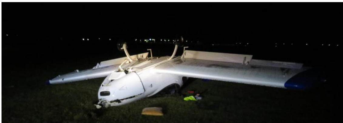
Rys. 1. Samolot PS-28 Cruiser SP-CFI – wrak samolotu po kapotażu (widoczne uszkodzenia konstrukcji oraz rozbita osłona kabiny).
