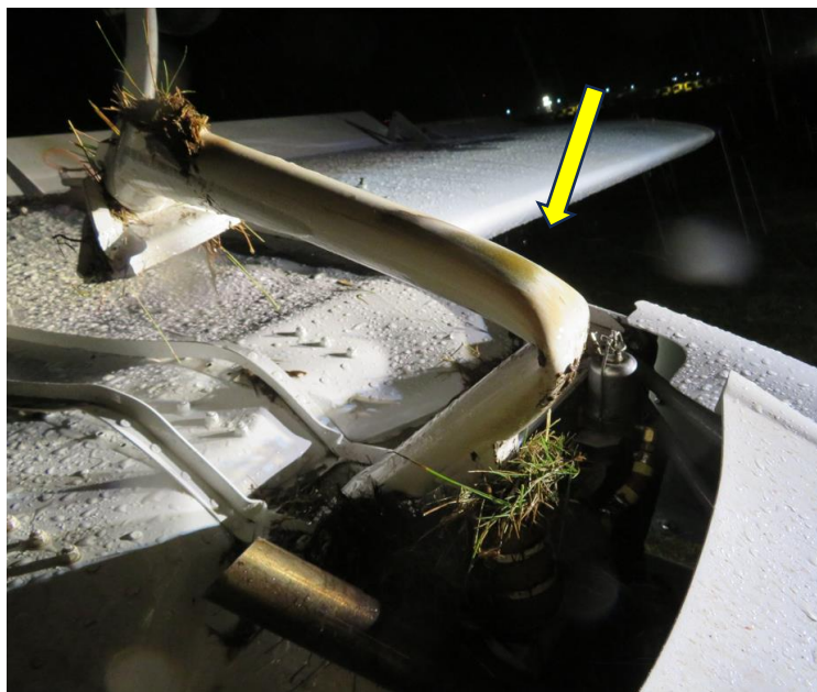
Rys. 3. Strzałką w kolorze żółtym wskazano złamaną podporę/goleń podwozia przedniego.
