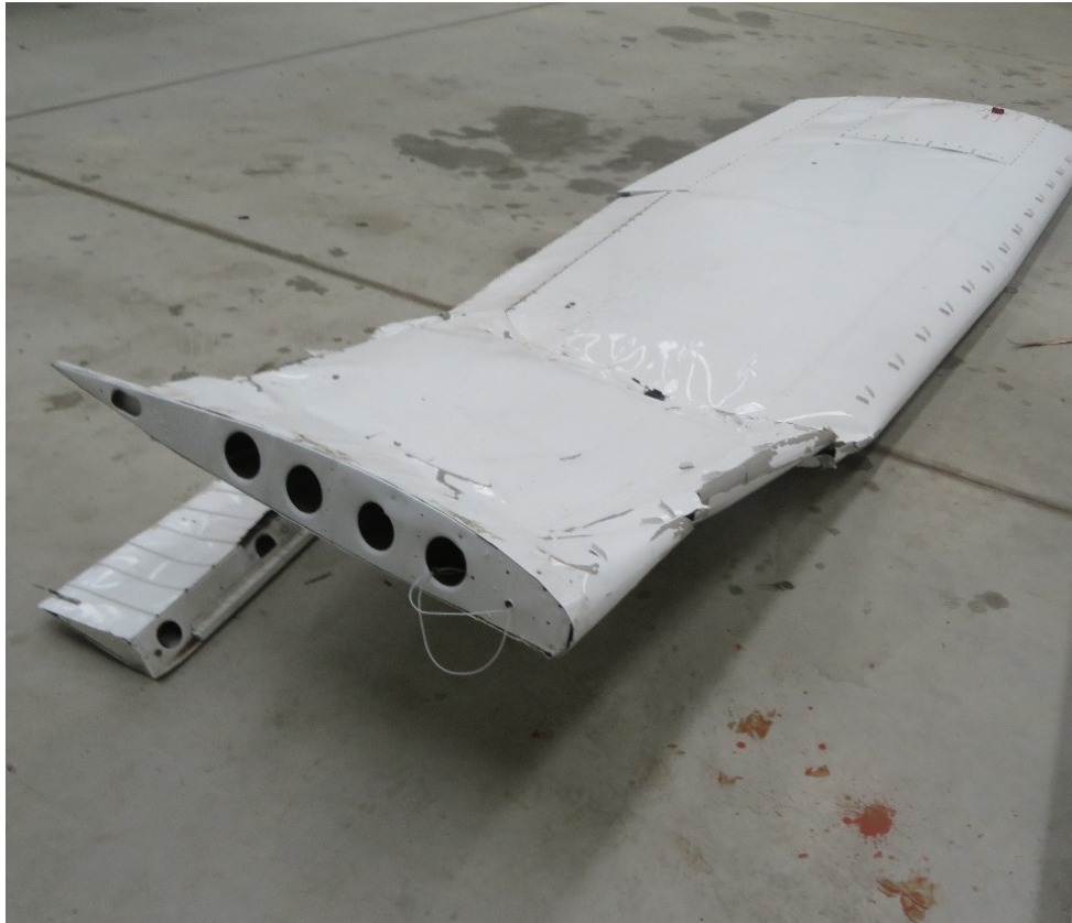
Rys.1. Zniszczone prawe skrzydło oraz urwana część lotki
