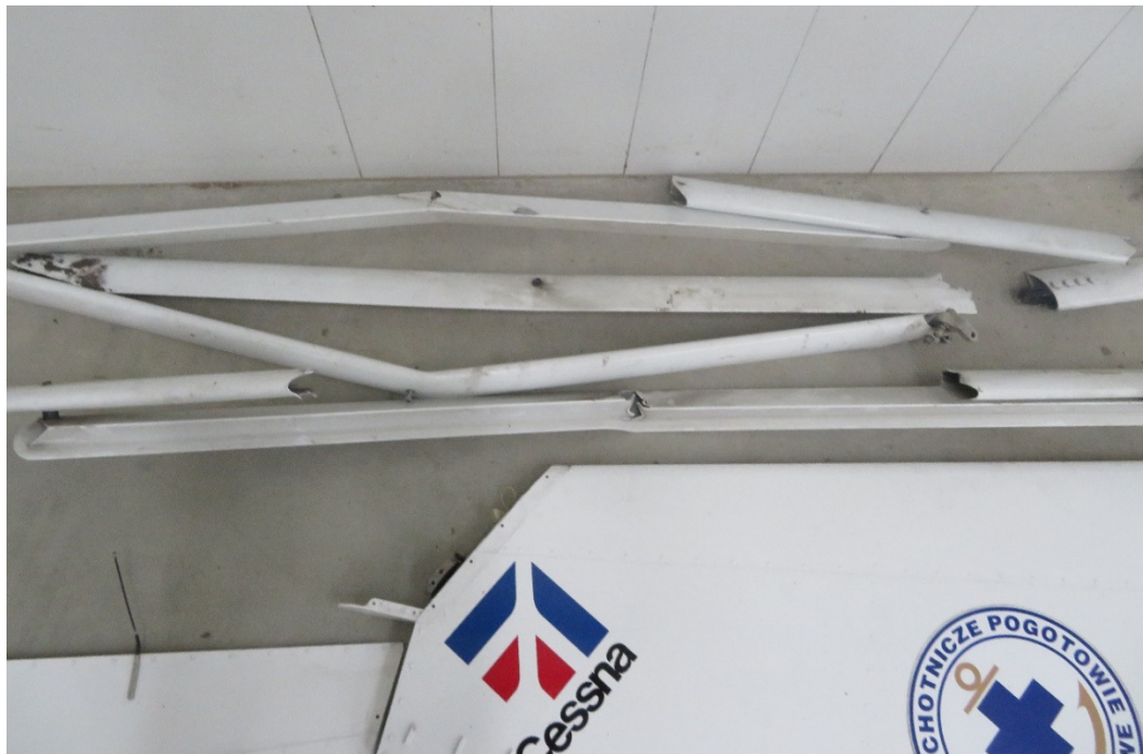
Rys. 2. Połamane i pocięte zastrzały mocujące pływaki
