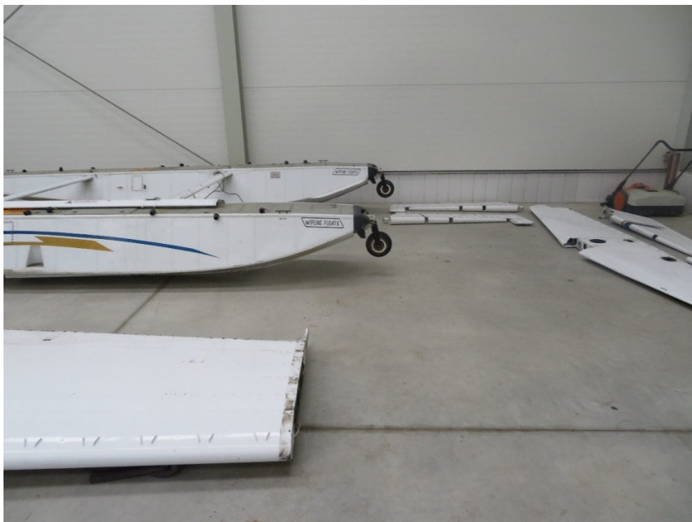
Rys. 5. Deformacja i przemieszczenie elementów mocowania pływaków do płatownca
