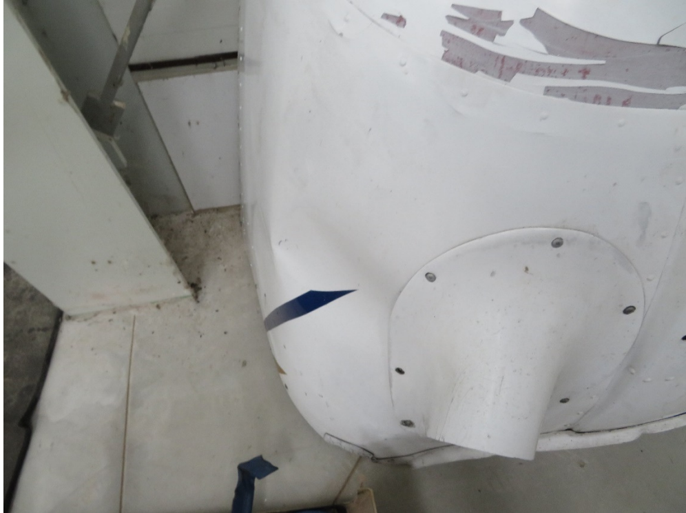
Rys. 3. Wgniecenia na dolnej masce silnika
