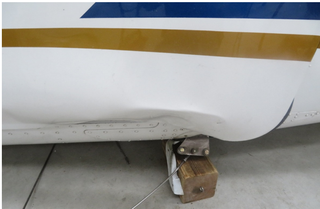
Rys. 4. Wgniecenia pokrycia lewych drzwi
