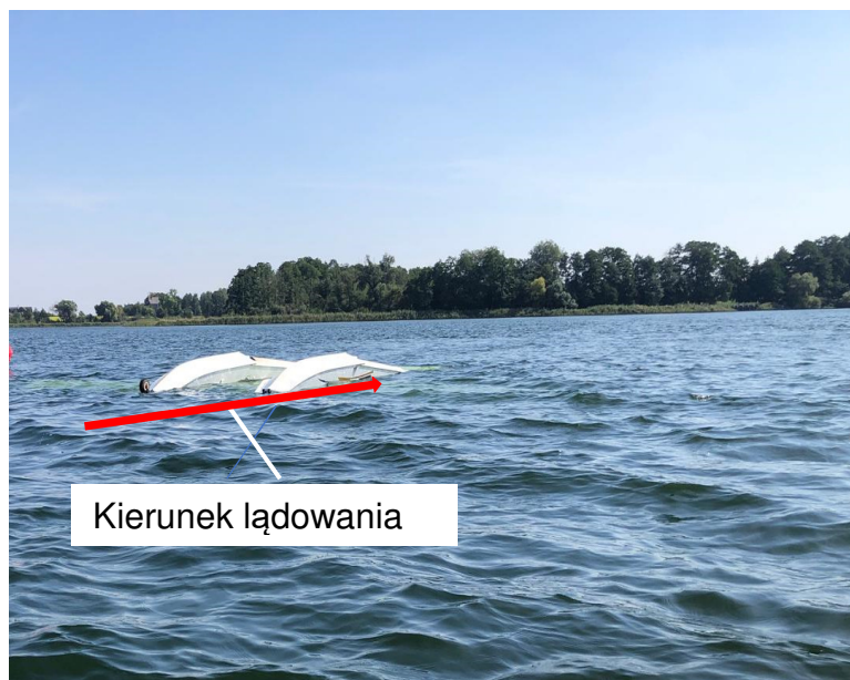
Rys. 8. Samolot po kapotażu z widocznym odchyleniem w lewo
