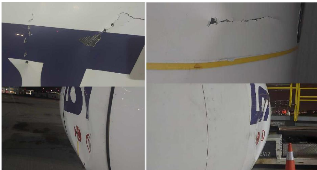
Rysunek 1. Widoczne wgniecenie oraz pęknięcie prawego silnika, Embraer E170 STD, SP-LDG. [źródło:LS Airport services S.A].
