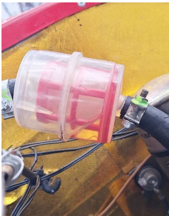
Rys. 1. Widok filtra paliwa po wypadku
