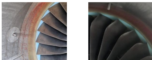
Rys.1. Ślady po wpadnięciu ptaka do silnika nr 1 oraz widoczne odkształcenie łopatek wentylatora silnika. (Źródło: podmiot badający zdarzenie).
