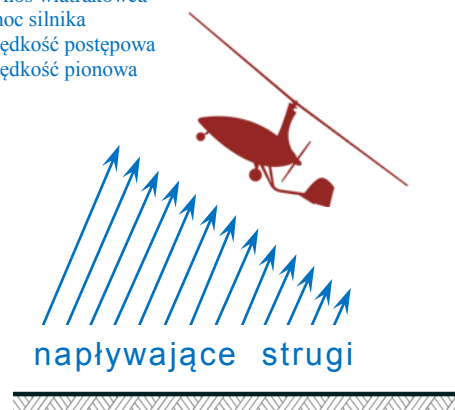
Rys. 3. Końcowa faza startu – „tonięcie” wiatrakowca [zdjęcie: świadek wypadku]
