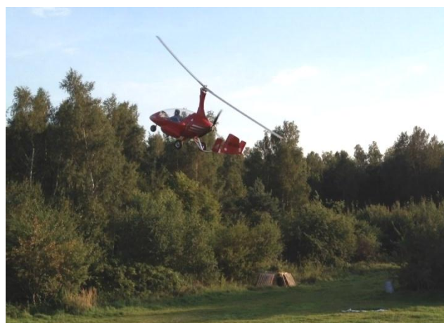
Rys. 3. Końcowa faza startu – „tonięcie” wiatrakowca [zdjęcie: świadek wypadku]
