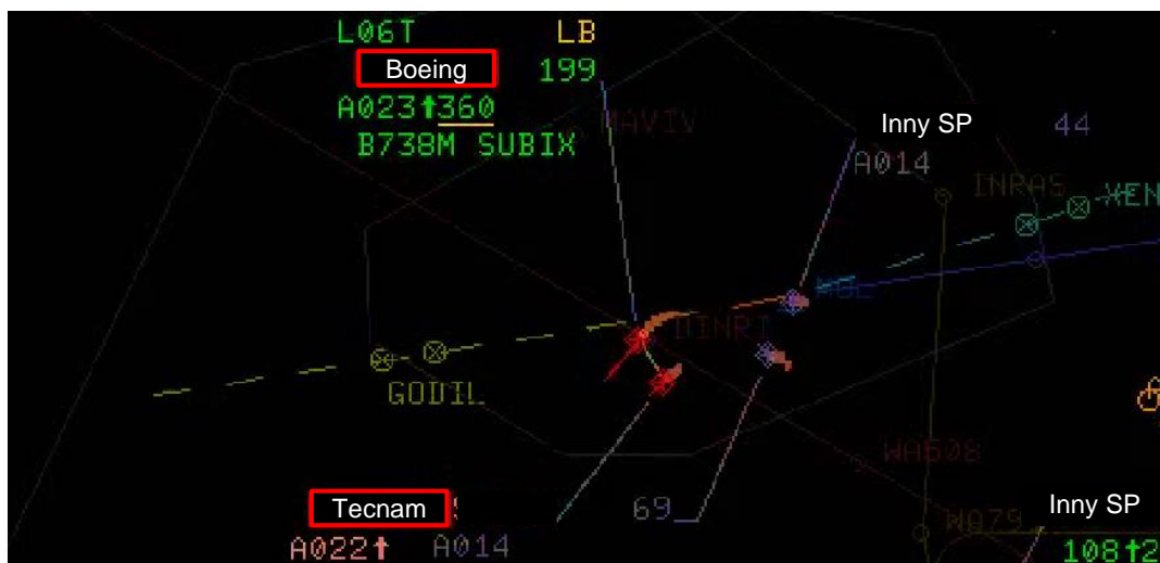
Rys. 3. Wycinek ekranu systemu PEGASUS_21 na stanowisku krl APP w czasie zbliżenia samolotów Tecnam i Boeing (zmieniono opisy SP) [źródło: PAŻP]
