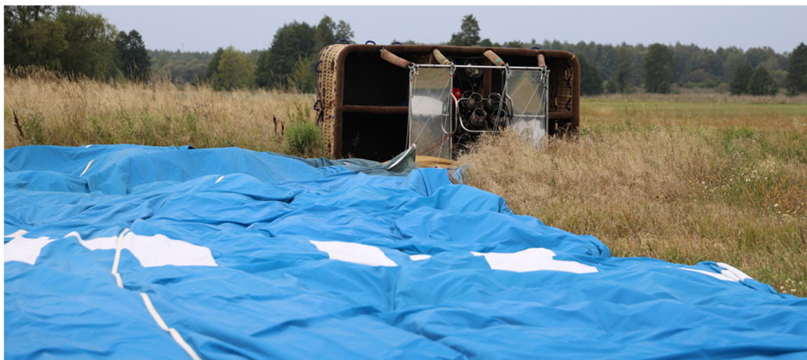
Rysunek 1. Przewrócony kosz z wyłączonymi palnikami i powłoką balonu bez powietrza na miejscu wypadku w miejscowości Rogówek k/Białegostoku. (źródło: PKBWL).
