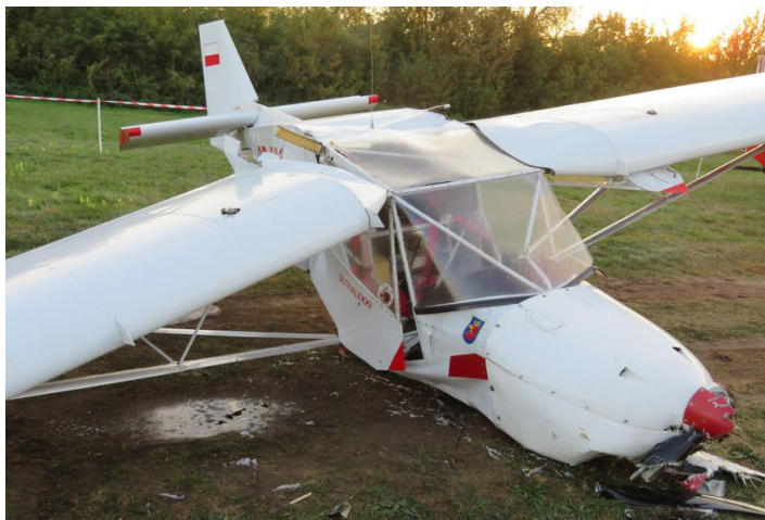
Rys 2. Wrak statku powietrznego STOLL TT2000 o znakach rejestracyjnych SP-SYPC po zderzeniu z pojazdami naziemnymi.
