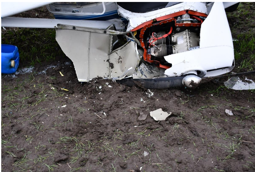
Rys. 7. Śmigło wygięte wzdłuż osi silnika. Osłony silnia rozerwane podczas akcji ratowniczej (w celu odłączenia instalacji elektrycznej)
