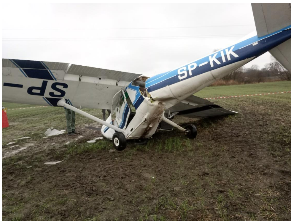
Rys. 2. Przełamanie kadłuba za kabiną załogi
