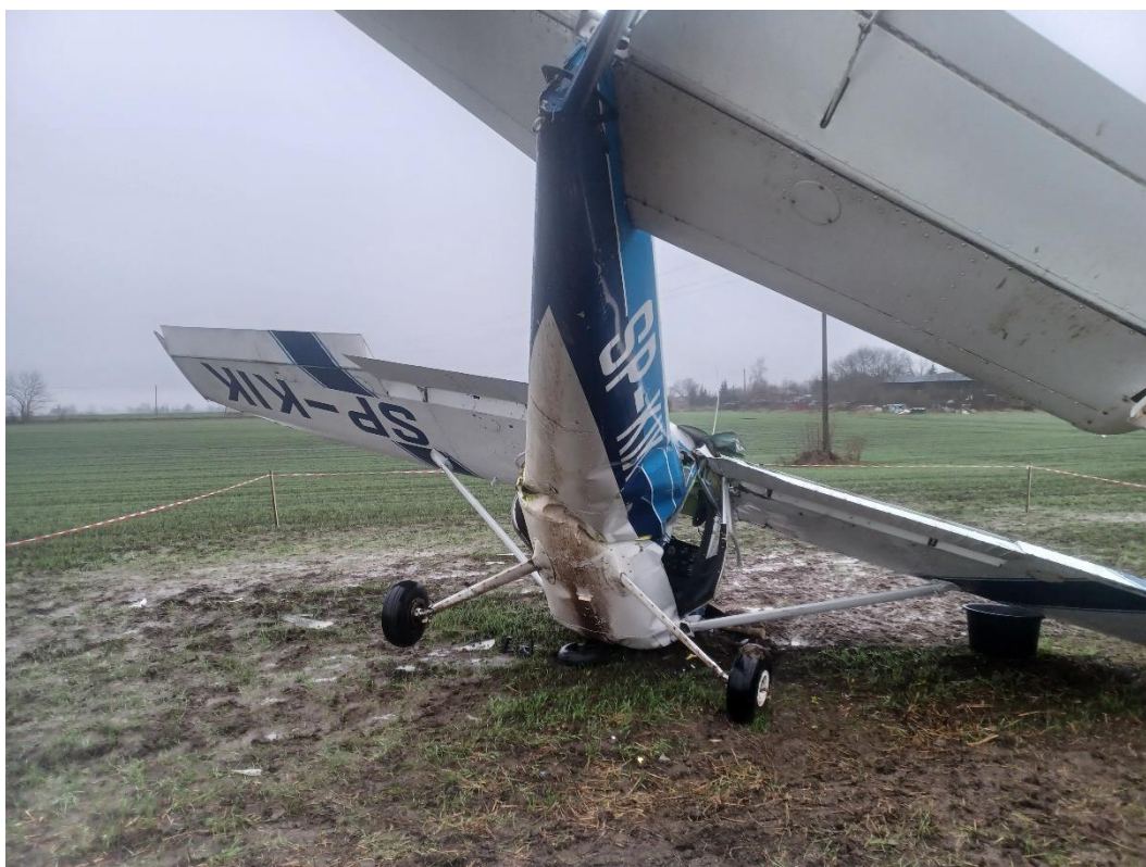
Rys. 6. Uszkodzenie (przełamanie) kadłuba w widoku od strony ściskanej. Pod kadłubem widoczna wybudowana goleń podwozia przedniego. Widoczne również oderwane prawe skrzydło
