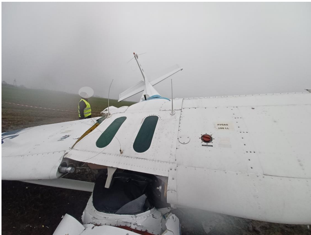
Rys. 3. Uszkodzone mocowania prawego skrzydła
