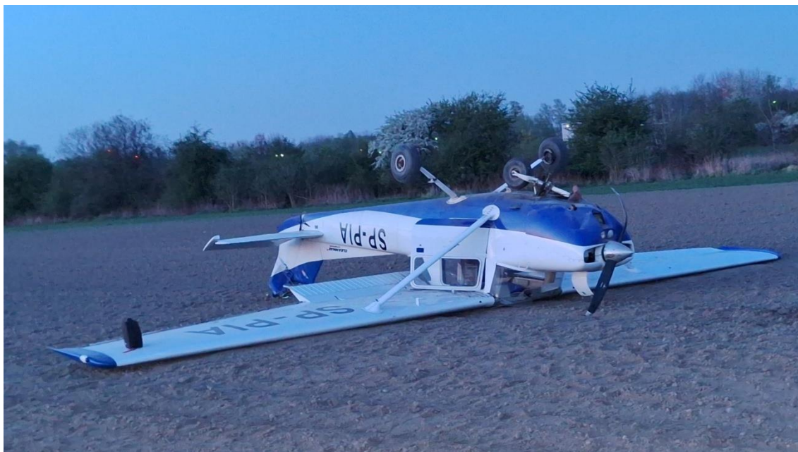
Rys. 1. Samolot Cessna F150M SP-PIA po kapotażu
