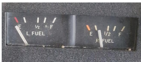
Rys. 2. Wskazania paliwomierzy samolotu w dniu 17.04.2025 (przy włączonym zasilaniu) po opróżnieniu zbiorników. [źródło FDA]
