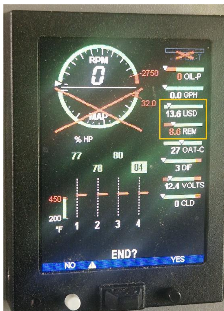
Rys.3. Wskazania monitora EDM (pomarańczowym kolorem zaznaczono informację, że pozostało 8,6 gal paliwa) [źródło FDA]
