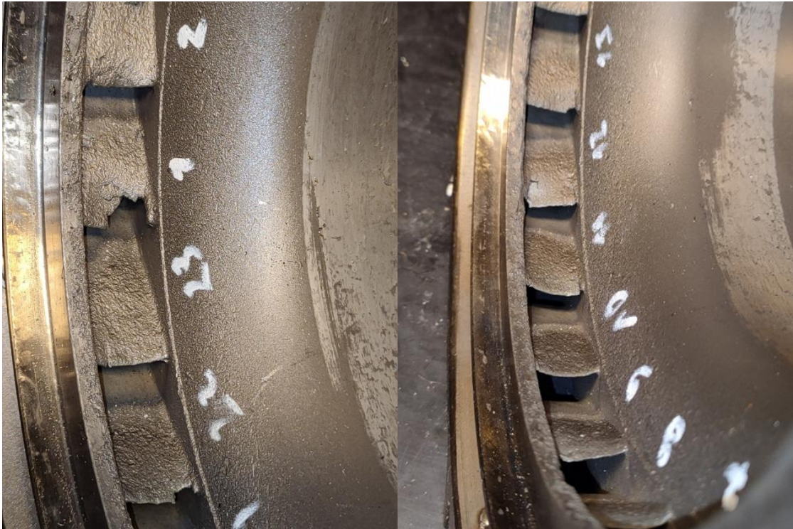
Rys. 4. Stator turbiny śmigłowca SP-HTMS [źródło: PKBWL].
