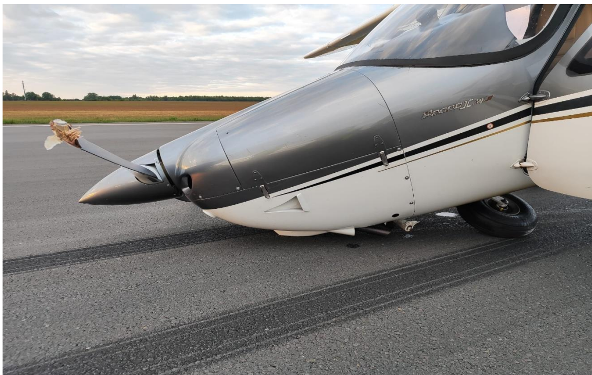
Rys. 1 Widok uszkodzonej przedniej gołeni oraz łopaty śmigła [Źródło: użytkownik]
