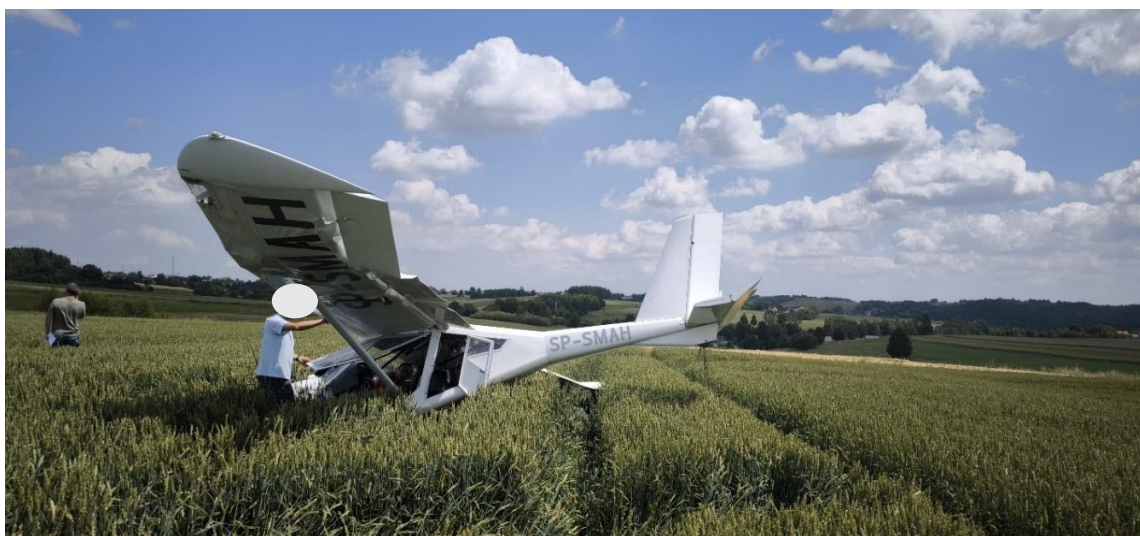
Rysunek 1. Samolot po wypadku. Widoczne uszkodzenia skrzydeł, złamana goleń podwozia przedniego oraz uszkodzone podwozie główne.
