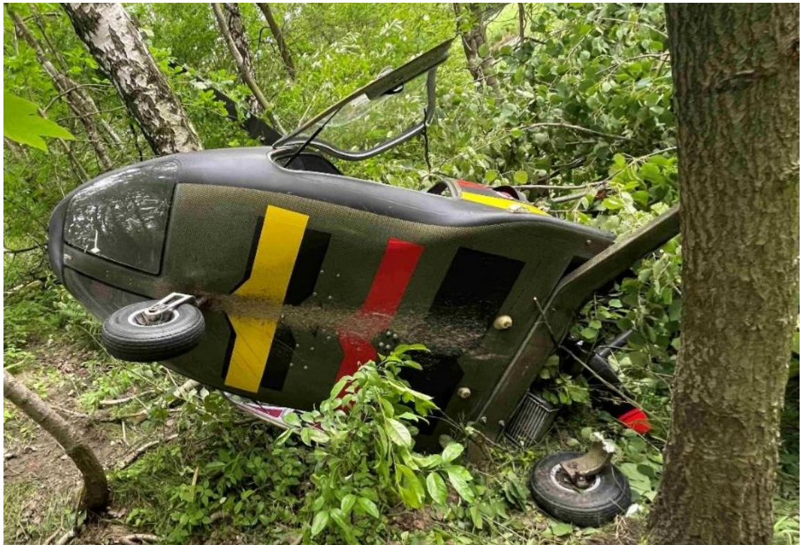
Rys. 2. Wiatrakowiec SP-XGLI po lądowaniu awaryjnym w Świętochłowicach – widok od dołu. [źródło: PKBWL]
