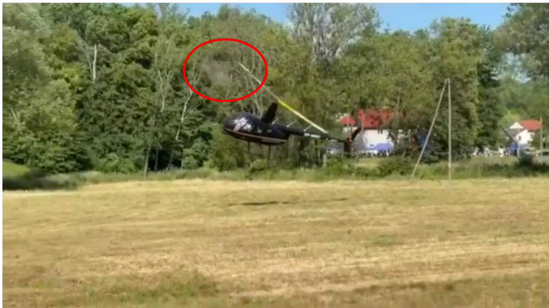
Rys. 2 Śmigłowiec w chwili zaczepienia wirnikiem o linię energetyczną. Czerwoną elipsą zaznaczono miejsce kolizji [źródło: Internet]
