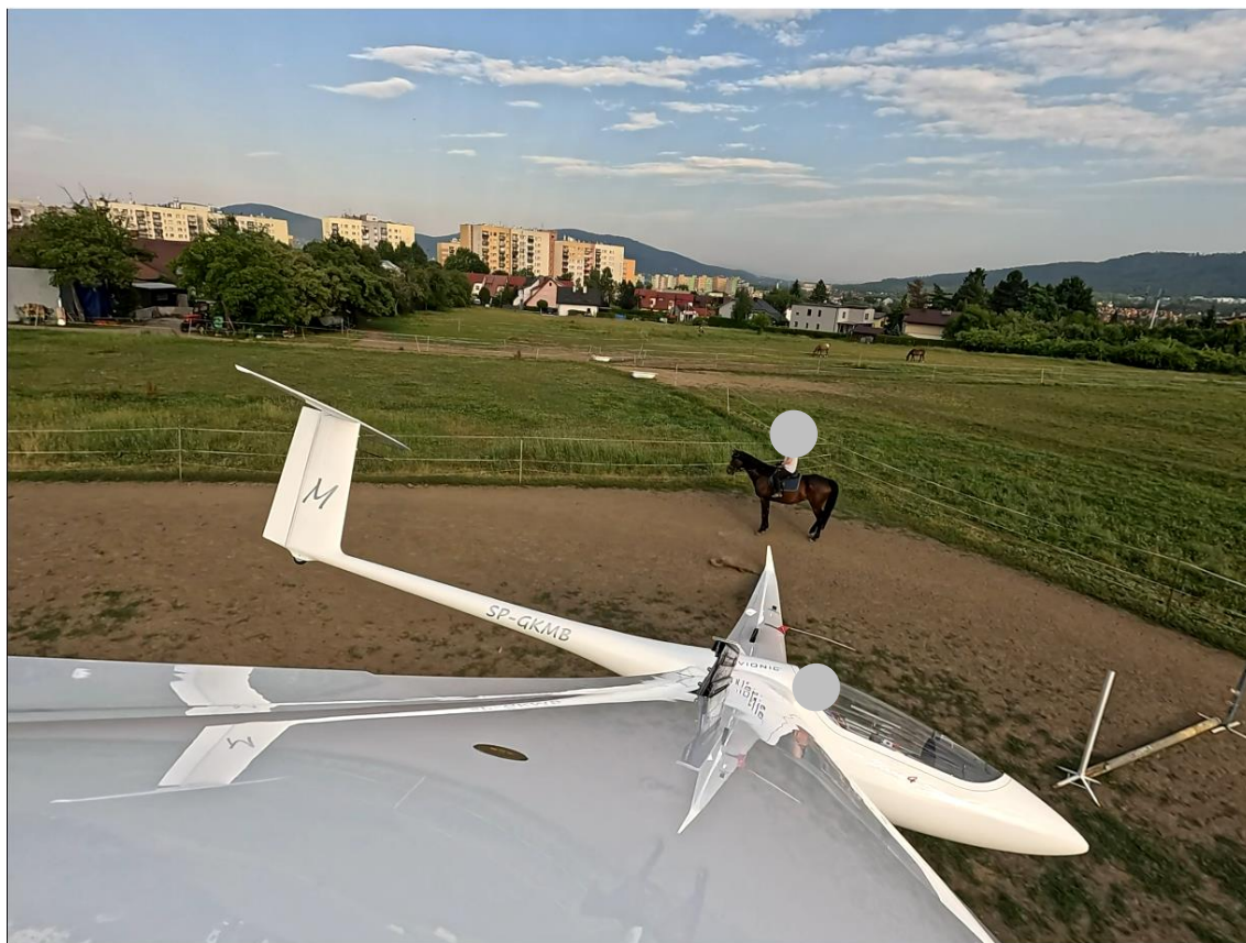
Rys. 11 Kolizja końcówki lewego skrzydła z ziemią (widoczne przytarcie-śląd) w początkowej fazie korkociągu.
