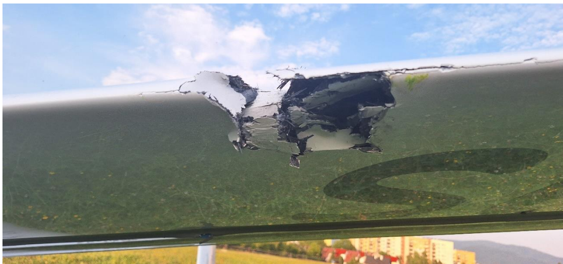
Rys. 5 Rozerwany w wyniku kolizji z przeszkodami keson lewego skrzydła.
