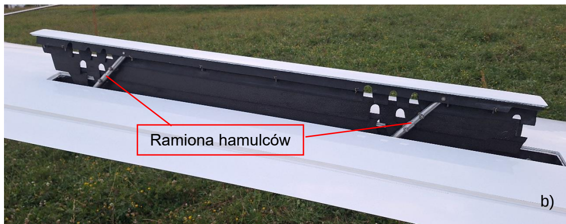
Rys. 13 Skrzynka i hamulec aerodynamiczny lewego skrzydła, widok od przodu (a) i od tyłu (b). Widoczne są poszczególne płyty (rys. a) oraz ramiona (rys. b), wraz ze sworzniami mocującymi.
