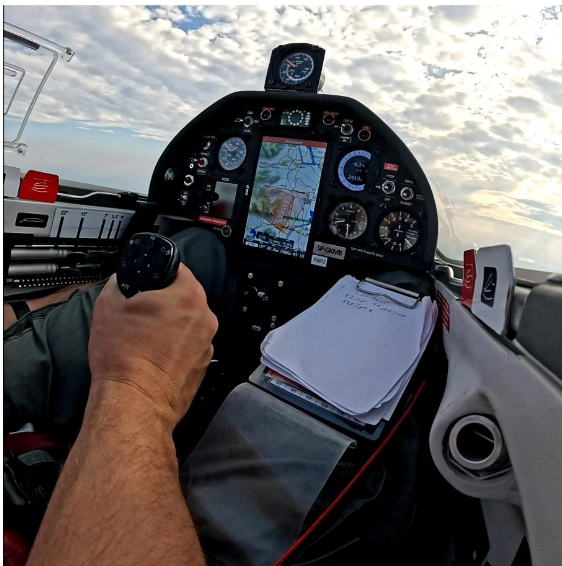
Rys. 8 Widok z kamery w kabinie, zarejestrowany na 2 s przed otwarciem hamulców aerodynamicznych. W górnej części prostokątnego wyświetlacza komputera pokładowego pojawia się podświetlony na czerwono alert „Overspeed”. Zwraca uwagę ułożenie lewej dłoni pilota na uchwycie hamulców aerodynamicznych.
