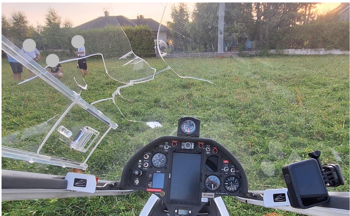
Rys. 7 Rozbite oszklenie osłony kabiny. Widoczna jest kamera, zamocowana do ramy osłony kabiny, po prawej stronie.
