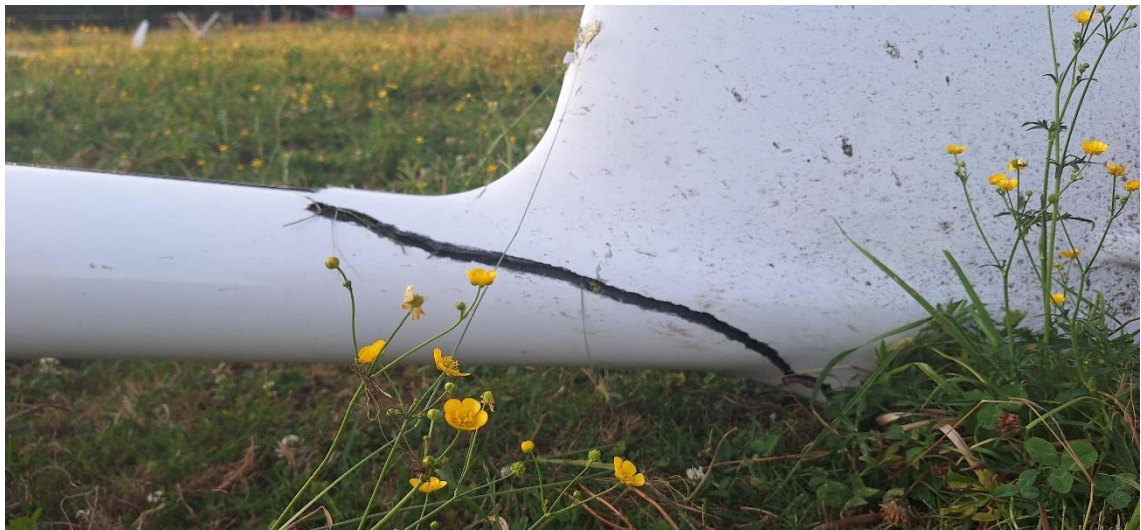
Rys. 6 Pęknięta belka ogonowa.
