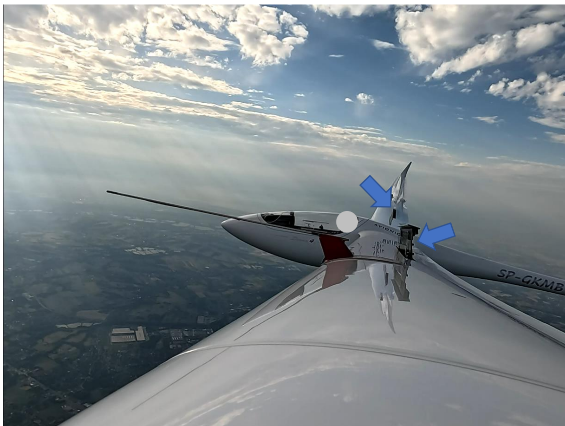
Rys. 1 Uchwycona chwila otwarcia hamulców aerodynamicznych (kadr z nagrania video). Hamulce pokazano niebieskimi strzałkami.
