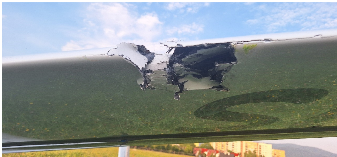
Rys. 2 Rozerwany w wyniku kolizji z przeszkodami keson lewego skrzydła [źródło: PKBWL].
