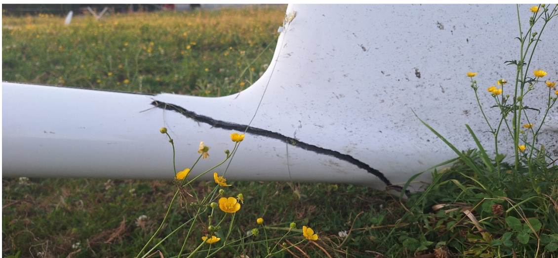
Rys. 3 Odlamana belka ogonowa wraz z usterzeniem [źródło: PKBWL].
