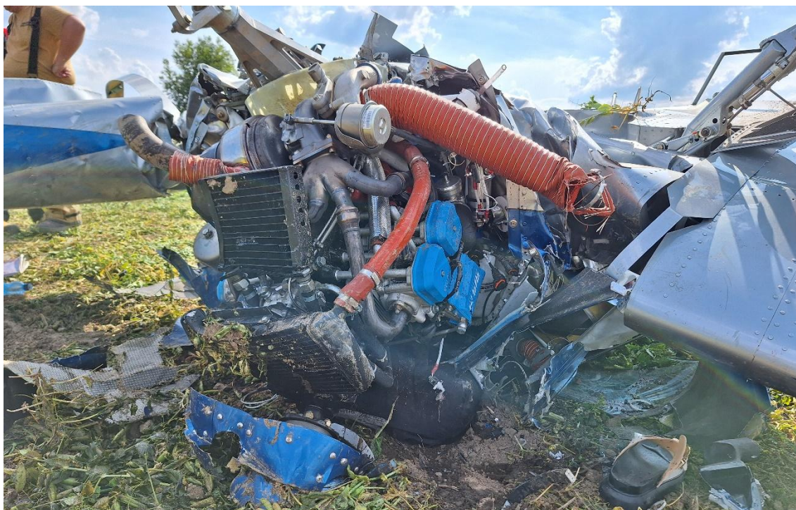
Rys. 3 Zniszczony zespół napędowy [źródło: PKBWL]
