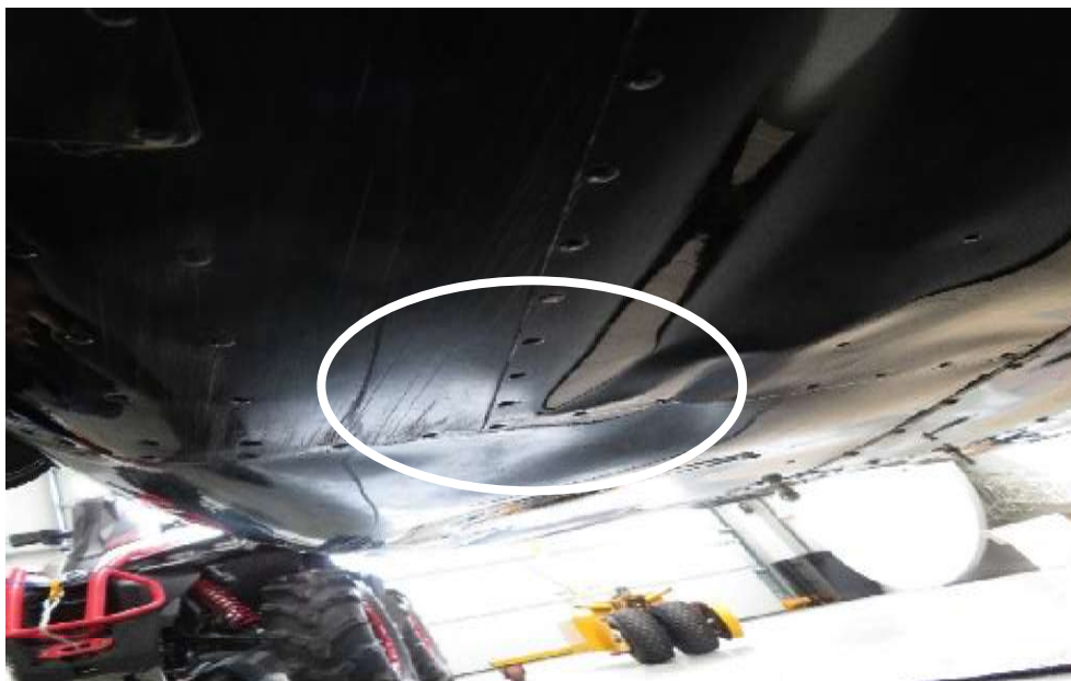
Rys. 8. Widoczne uszkodzenia dolnej części kadłuba
