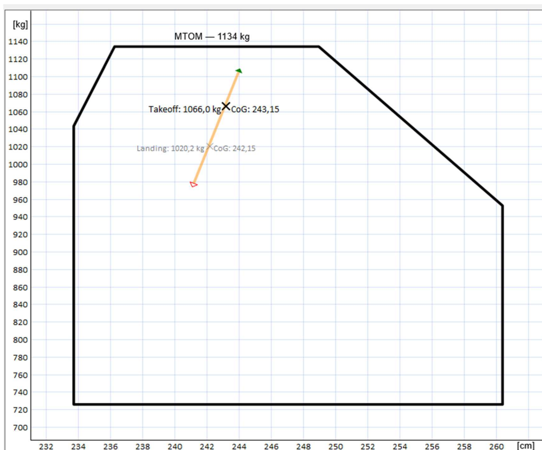
Rys. 5. Położenie środka ciężkości w osi podłużnej (czarny znacznik – masa do startu, czerwony znacznik – masa śmigłowca bez paliwa. Maksymalna masa do startu nie była przekroczona. Środek ciężkości podczas całego lotu znajdował się w prawidłowym położeniu.
