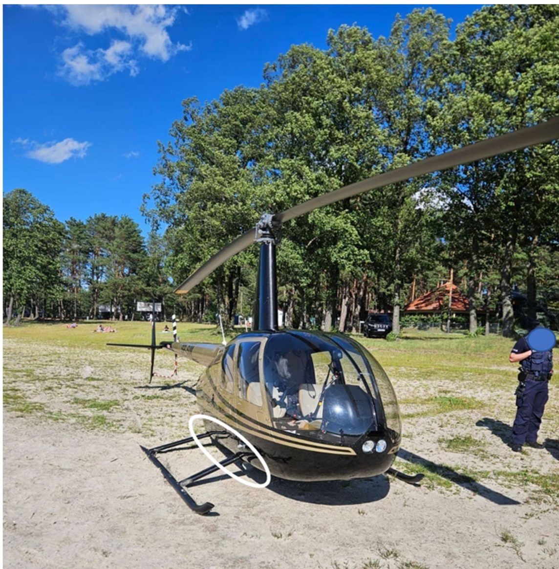
Rys. 7. Widoczne uszkodzenia podwozia płożowego [źródło: właściciel śmigłowca]
