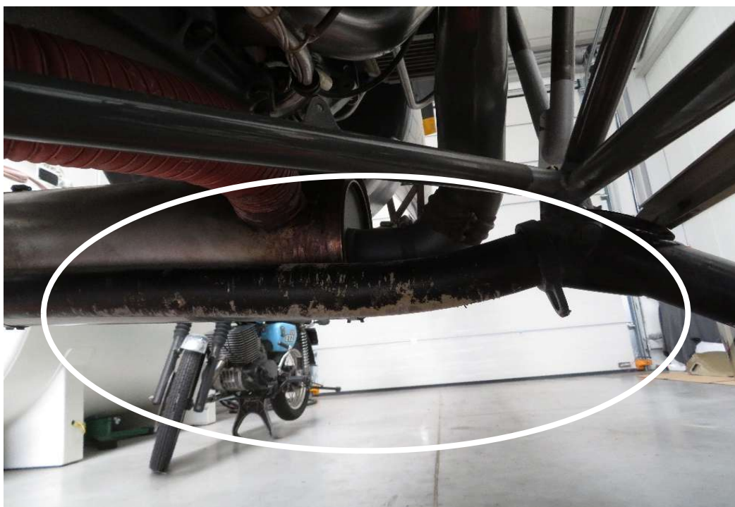
Rys. 11. Odkształcona tylna poprzeczka łącząca płozy (cross tube)
