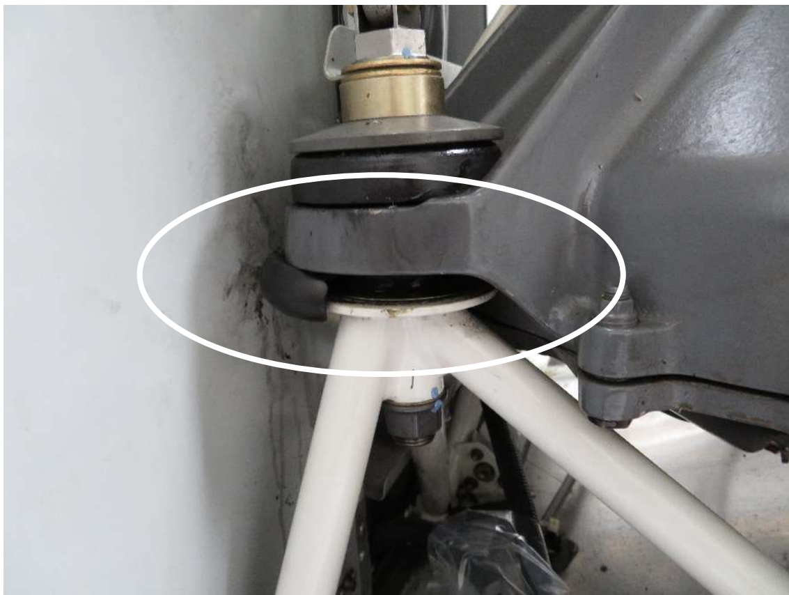
Rys. 10. Uszkodzony element zawieszenia przekładni głównej
