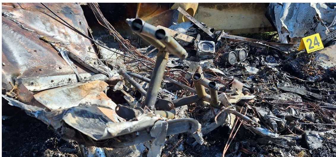
Rys. 9 Pozostałości po kabinie samolotu – widoczne m.in. pedały steru kierunku oraz nieliczne przyrządy pokładowe [źródło: PKBWL]
