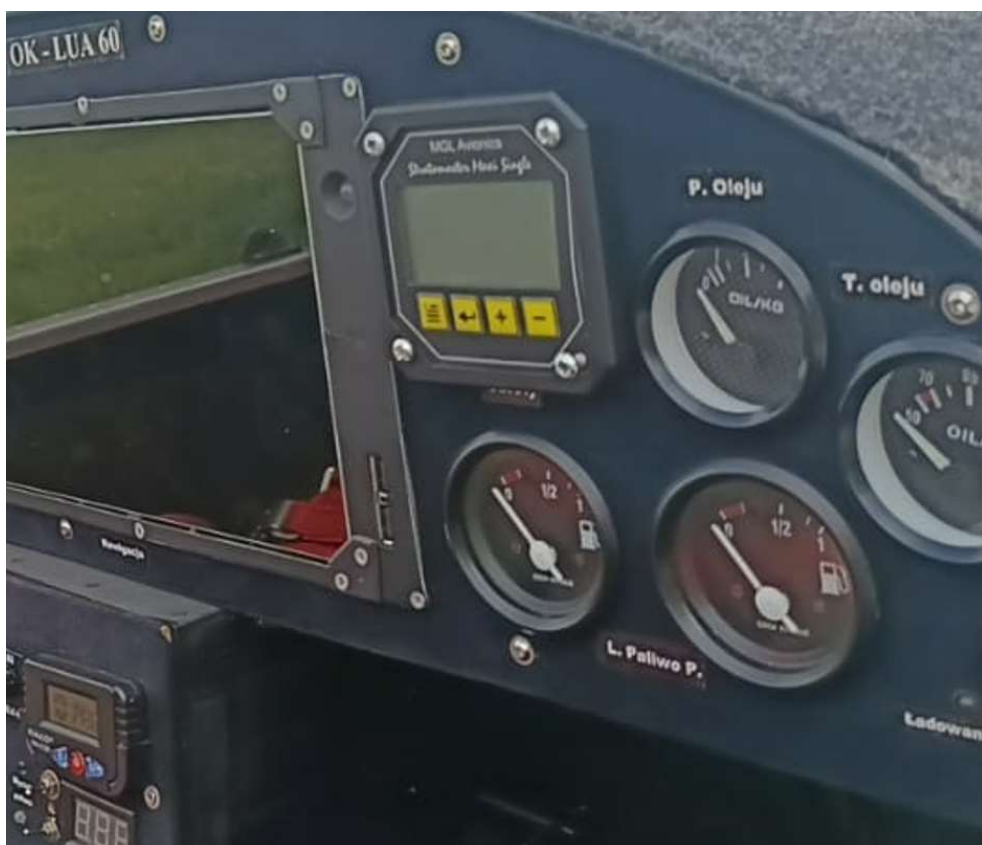
Rys. 15 Prawdopodobna konfiguracja przyrządów silnikowych [źródło: PKBWL]
