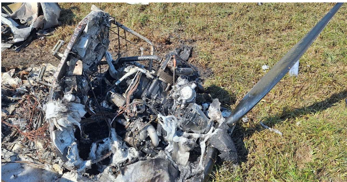
Rys. 7 Stan zespołu napędowego – oderwana ściana ogniowa wraz z łożem i silnikiem oraz piaśta z dwoma pozostałymi łopatom. Tkanina w kolorze białym to pozostałość po całkowicie spalonym okapotowaniu (maskach) silnika [źródło: PKBWL]
