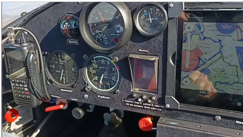
Rys. 14 Prawdopodobna konfiguracja przyrządów pilotażowych w samolocie Zodiak OK-LUA60 [źródło: PKBWL]
