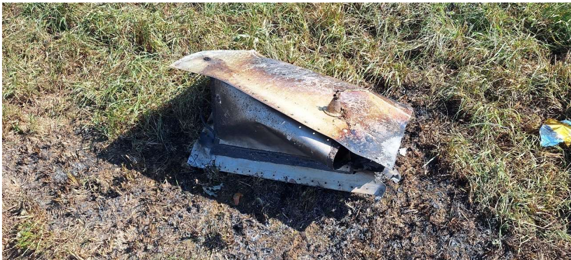
Rys. 6 Wyrwany z kesonu lewego skrzydła zbiornik paliwa [źródło: PKBWL]
