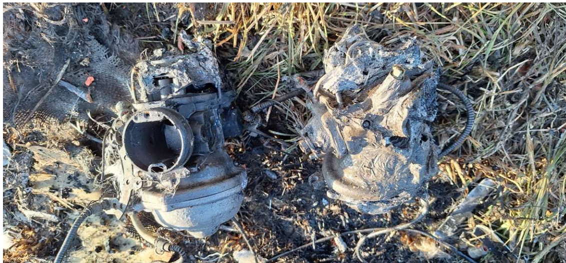
Rys. 8 Stan gaźników odnalezionych we wraku, częściowo stopionych pod wpływem wysokiej temperatury [źródło: PKBWL]
