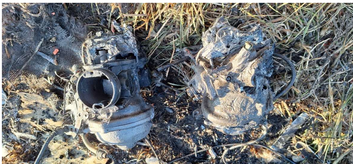
Rys. 10 Stan gaźników odnalezionych we wraku, częściowo stopionych pod wpływem wysokiej temperatury [źródło: PKBWL]
