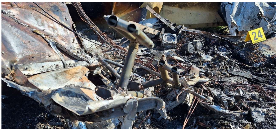
Rys. 11 Pozostałości po kabinie samolotu – widoczne m.in. pedały steru kierunku oraz nieliczne, pozostałe przyrządy pokładowe [źródło: PKBWL]
