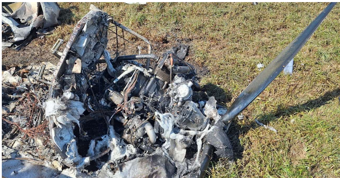
Rys. 9 Stan zespołu napędowego – oderwana ściana ogniowa wraz z łożem i silnikiem oraz piaśta z dwoma pozostałymi łopatami. Tkanina w kolorze białym to pozostałość po całkowicie spalonym okapotowaniu (maskach) silnika [źródło: PKBWL]
