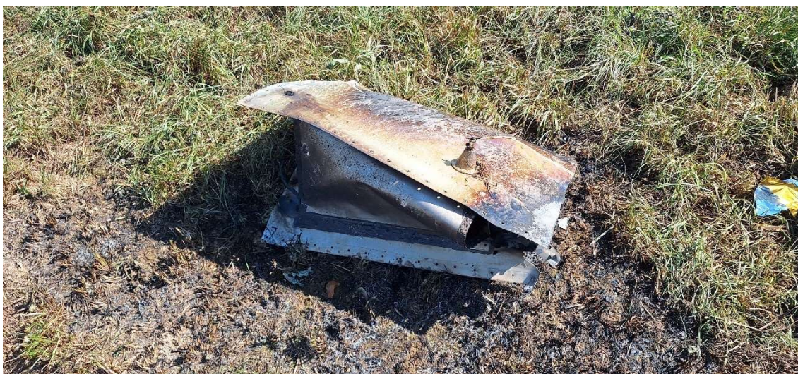
Rys. 8 Wyrwany z kesonu lewego skrzydła zbiornik paliwa [źródło: PKBWL]
