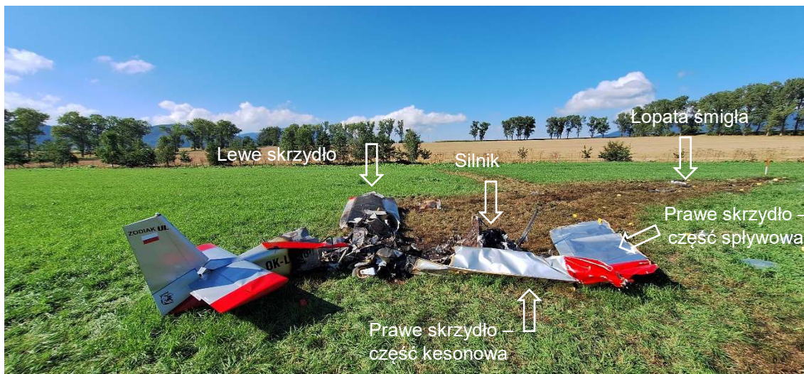
Rys. 7 Wrak na miejscu wypadku (widok na N) [źródło: PKBWL]
