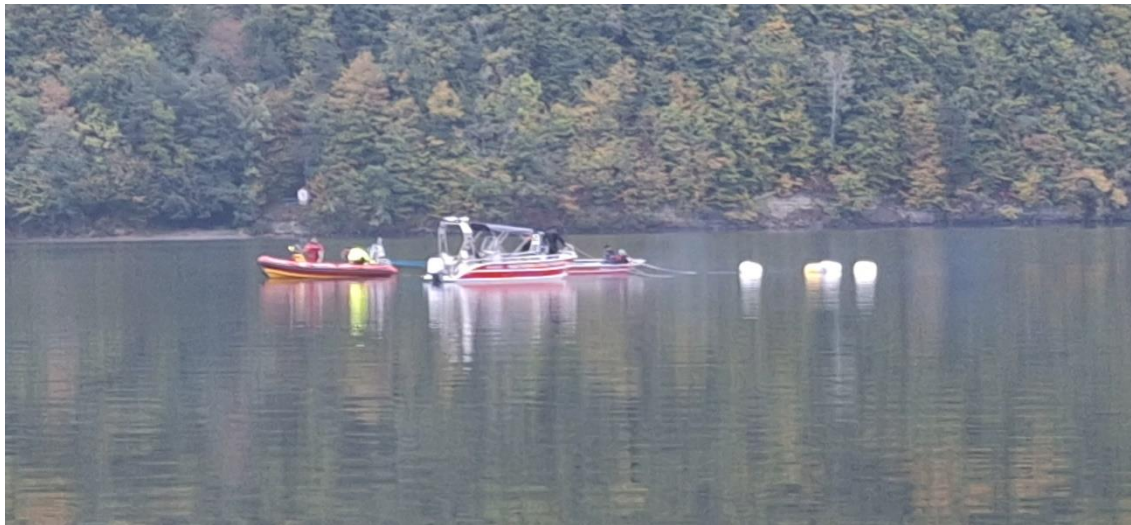
Rys. 5 Holowanie samolotu do brzegu – widok z nabrzeża od strony Międzybrodzia Bialskiego. Widoczne białe balony wypornościowe, samolot znajduje się pod powierzchnią wody [źródło: materiały PKBWL]
