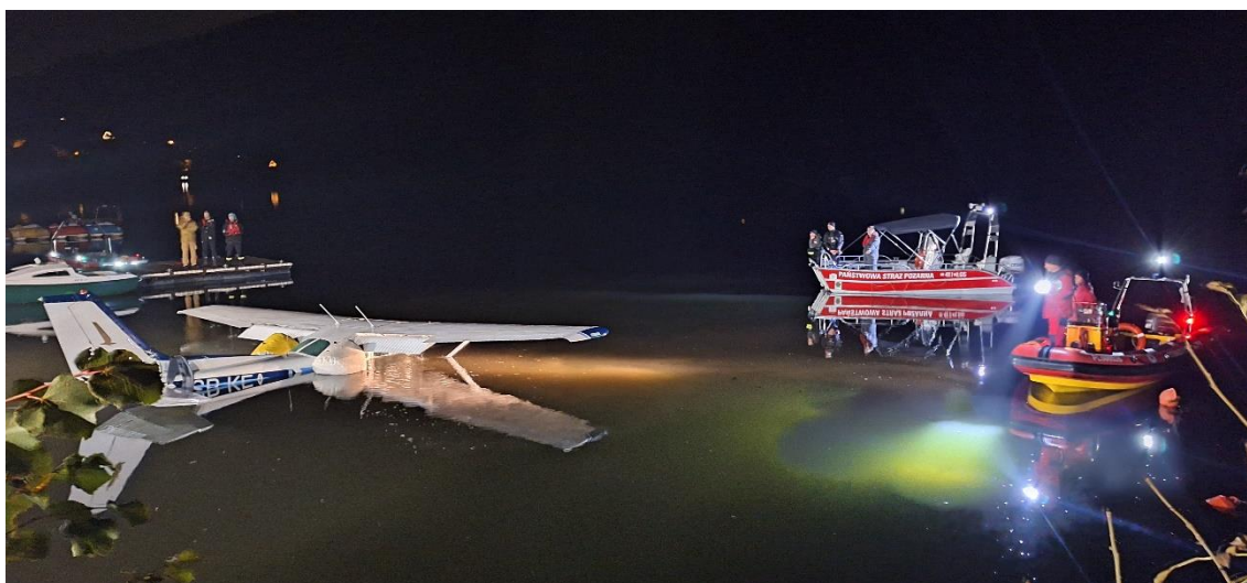
Rys. 6 Chwila wydobycia samolotu SP-KEA na brzeg jeziora. Widoczne kłapy wychylone do awaryjnego lądowania [źródło: materiały PKBWL]
