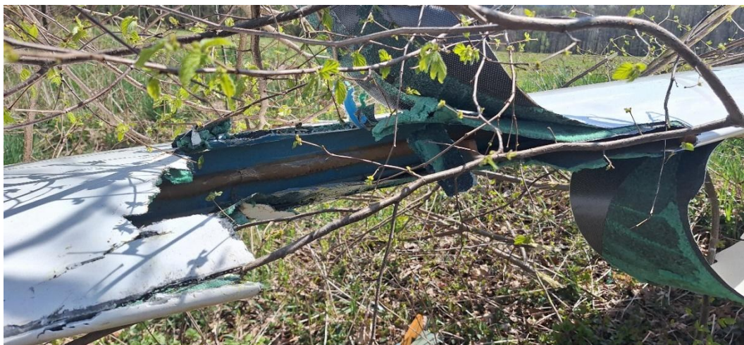
Rys. 4 Rozerwany w wyniku uderzenia o pień drzewa keson lewego skrzydła [źródło: PKBWL]
