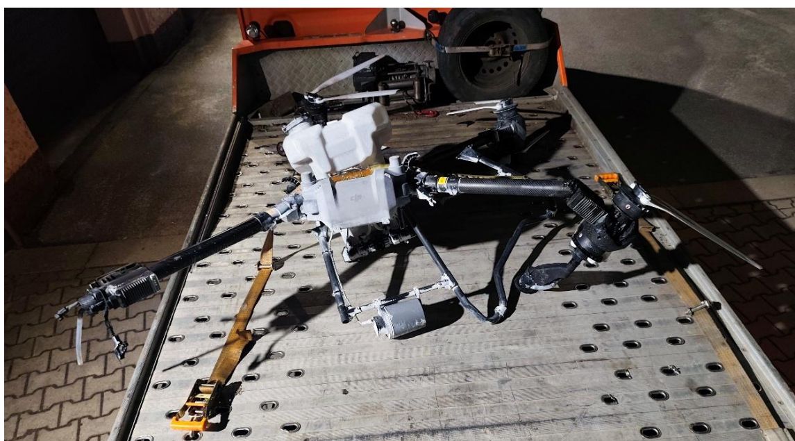
Rys. 3. Zniszczony BSP podczas transportu
