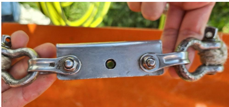
Rys. 8 Bezpiecznik typu TOST, z otworem kontrolnym (kolor czarny) na linie wyciągarkowej [źródło: PKBWL]
