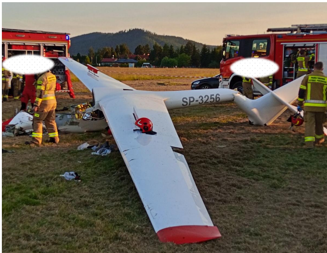
Rys. 6 Szybowiec SZD-50-3 po zderzeniu z nawierzchnią lotniska [źródło: PKBWL]
