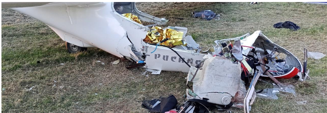
Rys. 7 Całkowicie zniszczona kabina załogi. Na pierwszym planie wybudowany, w wyniku uderzenia, fotel/oparcie przedniego siedziska [źródło: PKBWL]
