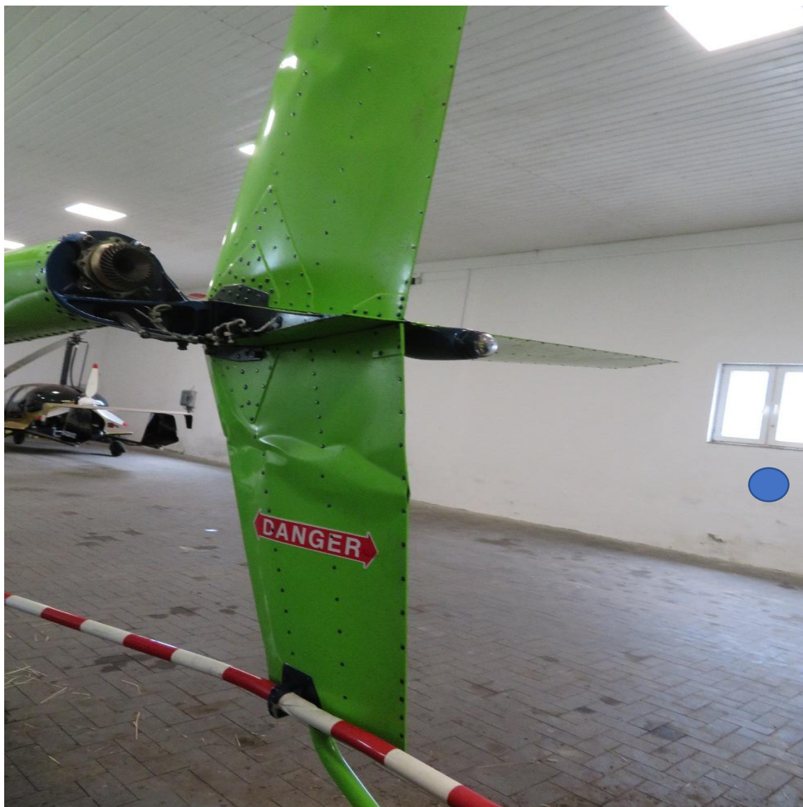
Rys. 3. Widoczny brak śmigła ogonowego oraz przekładni końcowej [źródło: PKBWL]
