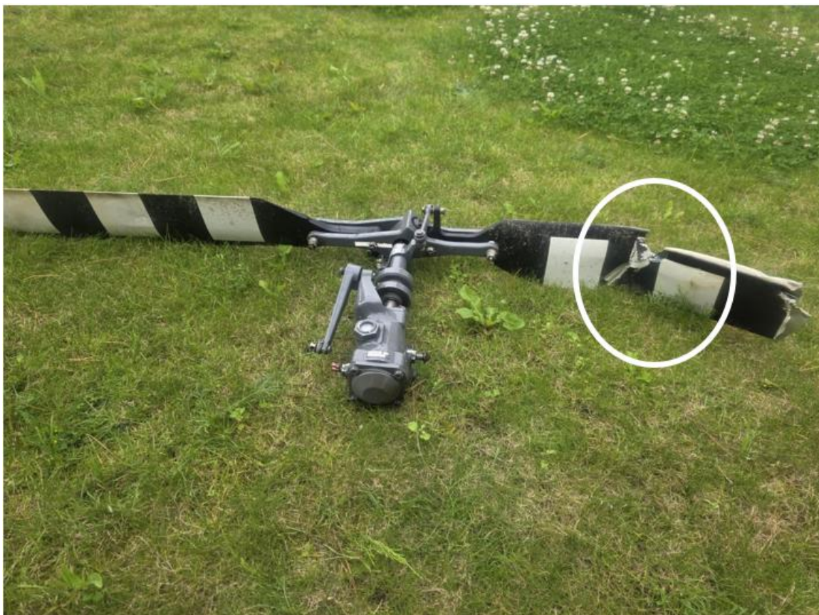
Rys. 5. Odseparowane śmigło ogonowe wraz z przekładnią kątową. Białym kolorem oznaczono miejsce zderzenia łopaty śmigła ogonowego i zerwania kolejnego przewodu linii wysokiego napięcia [źródło: PKBWL]
